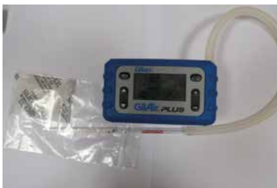
Zdj. 7. Aparatura do próbkowania pośredniego składająca się z aspiratora oraz tuby desorpcyjnej TENAX TA 19 .
