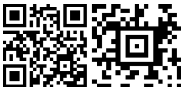
Rysunek 24. Porównanie kodów QR (z lewej) oraz Aztec (z prawej).
