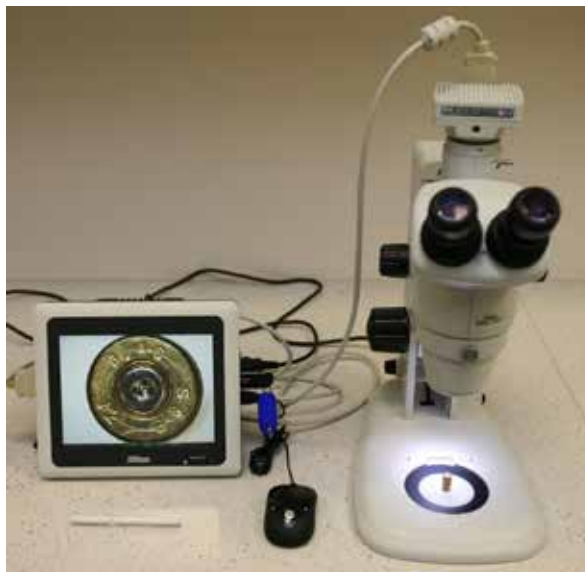
Zdj. 1. Mikroskop stereoskopowy zintegrowany z mikroskopową kamerą cyfrową i ciekłokrystalicznym ekranem.
