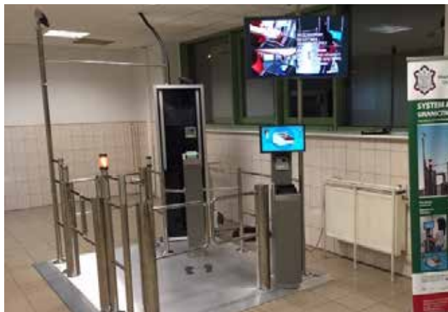
Rys. 2. Testowa bramka biometryczna opracowana przez Wojskową Akademię Techniczną. Źródło: http://www.ioe.wat.edu.pl/aktualnosc3/testy-systemu-do-automatycznej-odprawy-osob-na-przejsciu-granicznym-w-medyce/ [dostęp: 10 XII 2016].
