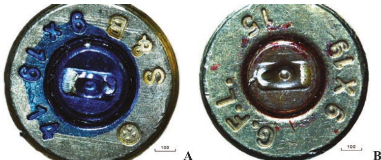
Zdj. 1. Denko łusek z amunicji S&B 9×19 mm Luger (A) oraz G.F.L. 9×19 mm Fiocchi (B) wykonane za pomocą stereomikroskopu 38 .
