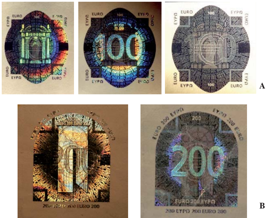
Fot. 23. Porównanie hologramu znajdującego się na banknocie euro (A) z jego imitacją (B).
