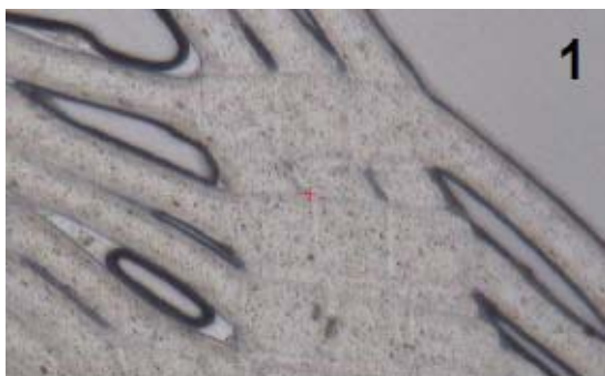
Fot. 12. Fragment białej nitki (do tkania) widziany pod mikroskopem w powiększeniu 200-krotnym, w świetle widzialnym w celi diamentowej. Zdjęcie wykonane aparatem fotograficznym wbudowanym w mikroskop podczerwieni HYPERION 2000 firmy Bruker.
