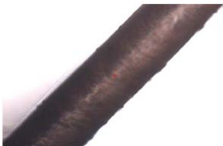
Fot. 4. Fragment powierzchni włosa ludzkiego widziany pod mikroskopem w 200-krotnym powiększeniu w świetle widzialnym. Zdjęcie wykonane aparatem fotograficznym wbudowanym w mikroskop podczerwieni HYPERION 2000 firmy Bruker.
