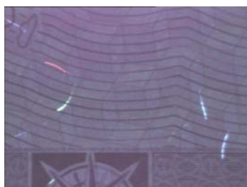
Rys. 9. Włókna zabezpieczające widoczne w promieniowaniu ultrafioletowym na stronie wyklejkowej.
