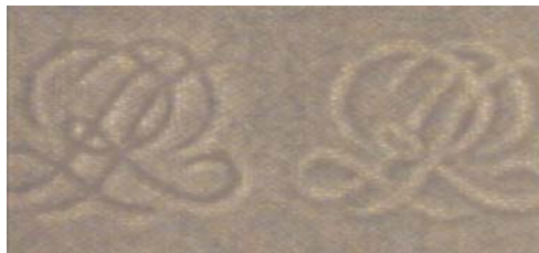
Rys. 12. Elementy zabezpieczające znajdujące się w strukturze papieru użytego do produkcji strony personalizacyjnej: znak wodny (a) i nitka zabezpieczająca (B).
